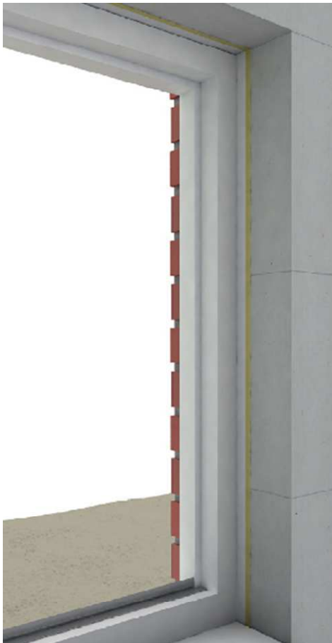
Naad afdichten met pur
